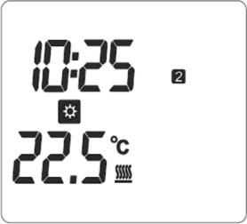
Beispiel Betriebsart „Komfort“
