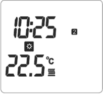
Beispiel Betriebsart „Komfort“
