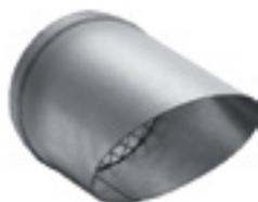
Terminale di presa aria esterna o espulsione in lamiera di acciaio zincato a semplice parete completo di rete di protezione antivolatili a maglia quadrata, profilo con taglio a 45° in funzione anti pioggia.
