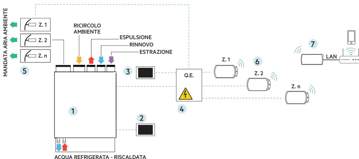
Adatto in tutte quelle soluzioni dove si vuole una regolazione della temperatura indipendente per ogni zona. La gestione del sistema avviene tramite termostati a contatto pulito o contatti da domotica.
