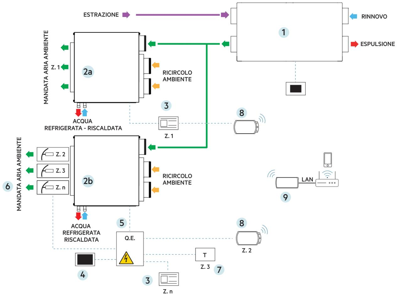
Sistema composto da due unità CLIMA. La prima unità serve un open space ed è controllata da un unico pannello di comando CNT, la seconda, completa di serrande di modulazione, serve in maniera indipendente più zone, tramite pannelli CNT, termostati ON/OFF a contatto pulito e sonde analogiche di temperatura.
