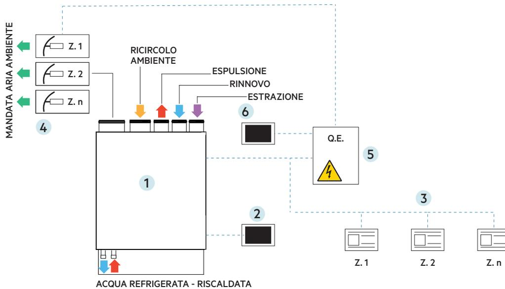
Adatto in tutte quelle soluzioni dove si vuole una regolazione della temperatura indipendente per ogni zona. I pannelli di controllo CNT con sonda di temperatura integrata, installati in ogni zona, permettono una gestione decentralizzata dell'impianto.
