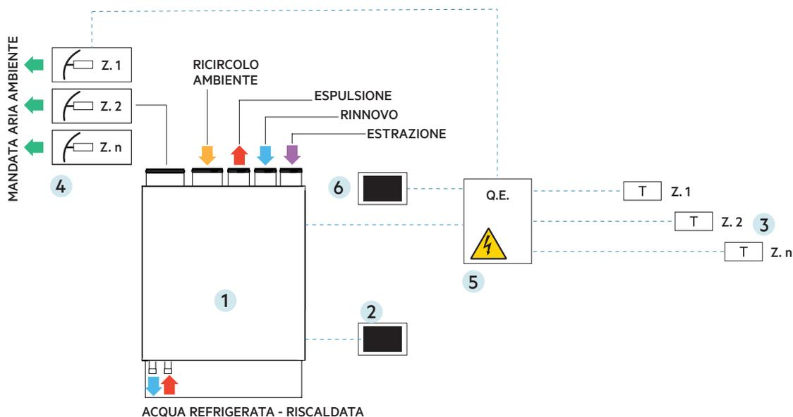
Adatto in tutte quelle soluzioni dove si vuole una regolazione della temperatura indipendente per ogni zona. La gestione del sistema avviene tramite un pannello di controllo centralizzato TGF. In ogni zona sono presenti delle sonde analogiche che rilevano la temperatura.
