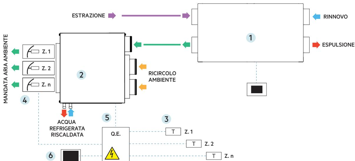
Adatto in tutte quelle soluzioni dove si vuole una regolazione della temperatura indipendente per ogni zona. La gestione del sistema avviene tramite un pannello di controllo centralizzato TGF.
