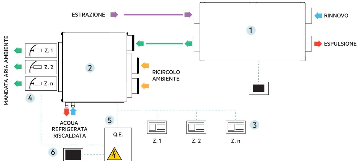
Adatto in tutte quelle soluzioni dove si vuole una regolazione della temperatura indipendente per ogni zona. I pannelli di controllo CNT con sonda di temperatura integrata, installati in ogni zona, permettono una gestione decentralizzata dell'impianto.
