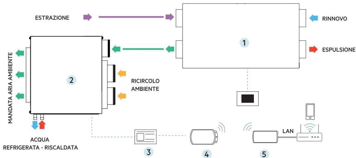
Adatto negli open space e in tutte quelle soluzioni dove non si vuole una regolazione della temperatura indipendente per ogni zona. Il sistema è gestito da un solo pannello di controllo CNT.
