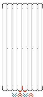
Allacciamenti idraulici saldati passo 50 mm
