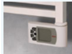
Resistenza elettrica ad innesto tramite fastom con controllo elettronico per regolare la temperatura ambiente, programmabile settimanalmente. Classe di isolamento II. Grado di protezione IP44. L'elettronica è fornita in colore Bianco Standard (cod. 01) con cavo bianco per radiatori bianchi; cromata con cavo grigio per radiatori colorati.
