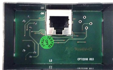
Collegamento pannello di comando all'unità
