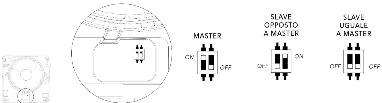
In caso di errori di configurazione o necessità di modificare l'assegnazione MASTER / SLAVE delle unità è necessario procedere in questo modo:
