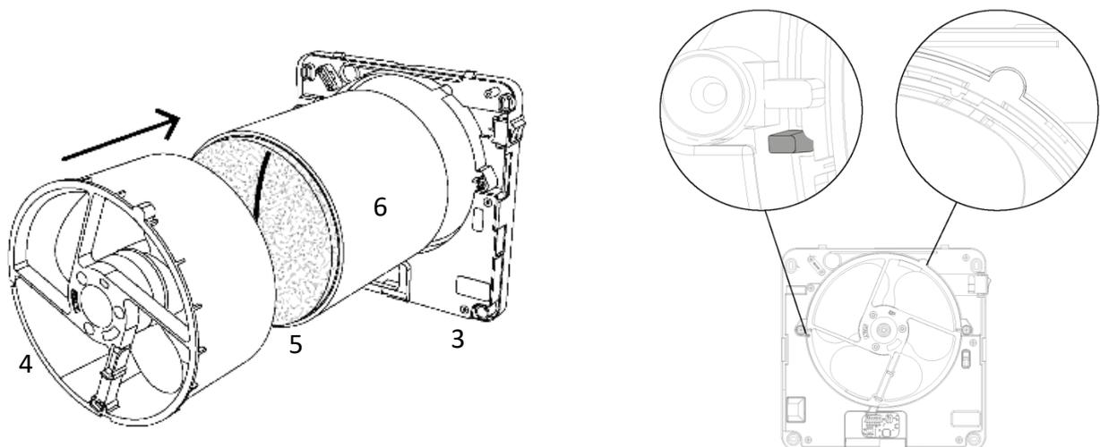
Bloccare il ventilatore ruotando i due fermi e bloccarli serrando le due viti. Inserire il connettore del cavetto di alimentazione del moto-ventilatore nella sua sede maschio sulla scheda.
