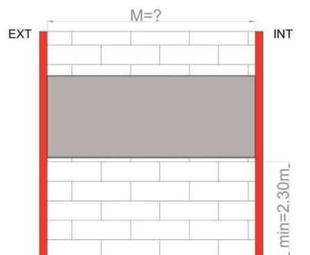
La quota "M" non può essere inferiore a 250 mm. Se la parete ha spessore inferiore, non è idonea per l'installazione dell'apparecchiatura.
