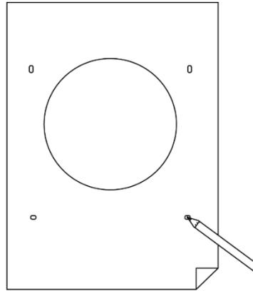
Tracciare i fori per i tasselli di fissaggio della piastra di supporto utilizzando una livella per una installazione precisa. Realizzare i fori ed avvitare la piastra al muro:
