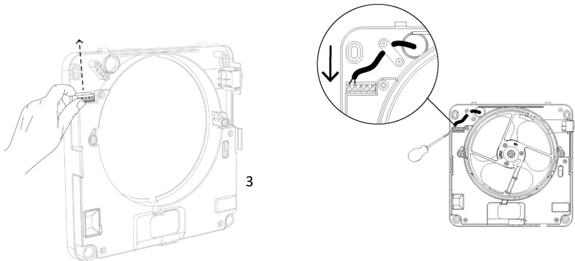
Inserire lo scambiatore (6) e il moto-ventilatore (4). Un dente e relativa scanalatura alla sinistra (figura sotto) permettono di individuare la corretta posizione per inserire il moto-ventilatore. Fare attenzione al cavetto di alimentazione che deve rimanere alloggiato entro la propria sede.
