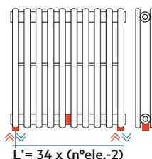
Conexiones hidráulicas soldadas
