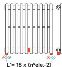
Conexiones hidráulicas soldadas
