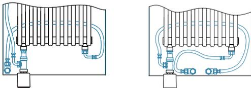
Todos los modelos RELAX RENOVA incluyen un innovador sistema de conexión hidráulica oculto mediante tubos flexibles de alta calidad, que permiten la sustitución de radiadores ya instalados sin la modificación de los entre eje. También incluye adaptador para cabezal termostático. Todo el sistema queda oculto en la parte inferior del panel.
