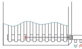
Para instalaciones monotubo la válvula queda vista tanto en la entrada lateral derecha o lateral izquierda.
