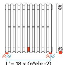
Conexiones hidráulicas soldadas
