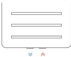
Conexión Bitubo por abajo con entre eje 50 mm.
