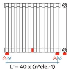
Conexiones hidráulicas soldadas
