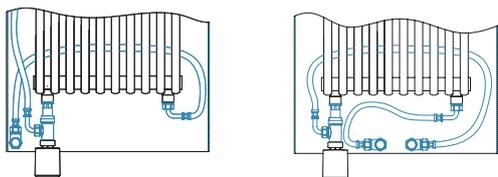
Todos los modelos RELAX STYLE incluyen un innovador sistema de conexión hidráulica oculto mediante tubos flexibles de alta calidad, que permiten la sustitución de radiadores ya instalados sin la modificación de los entre eje. También incluye adaptador para cabezal termostático. Todo el sistema queda oculto en la parte inferior del panel.
