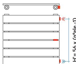
Conexiones hidráulicas soldadas
