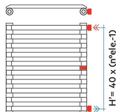
Conexiones hidráulicas soldadas
