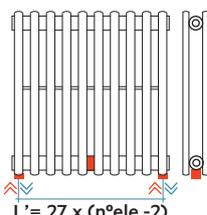
Conexiones hidráulicas soldadas
